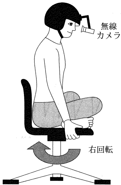
図4 回転刺激と眼球運動との関係を調べる実験
